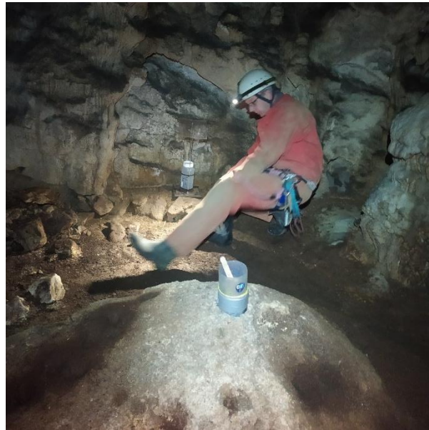
Figure 38 : Au premier plan, carottage dans le tas de guano. Au second plan, relève du capteur de pollen dans le Gouffre du Creux-à-Pépé.
